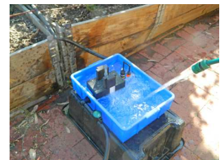
Fill the evaporator
