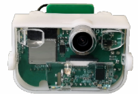
LPWAN sensor module
