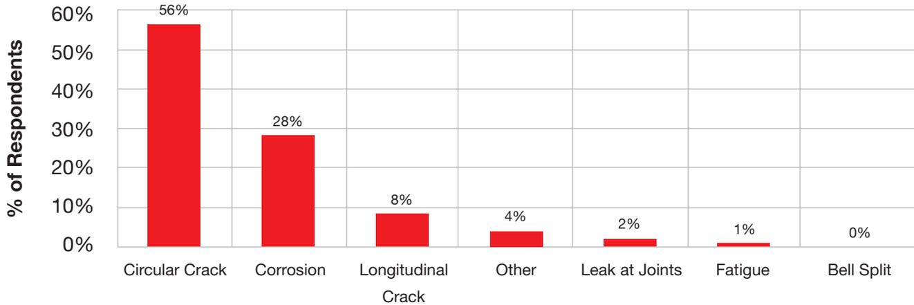
**FIGURE 28: DISTRIBUTION OF FAILURE MODES FROM THE BASIC SURVEY**
