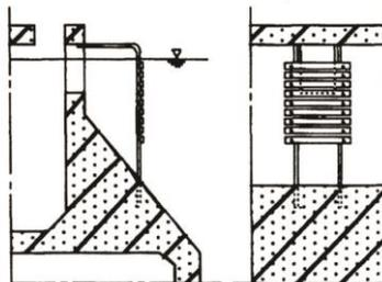
Figure 4.6.3 Baffle Plate
