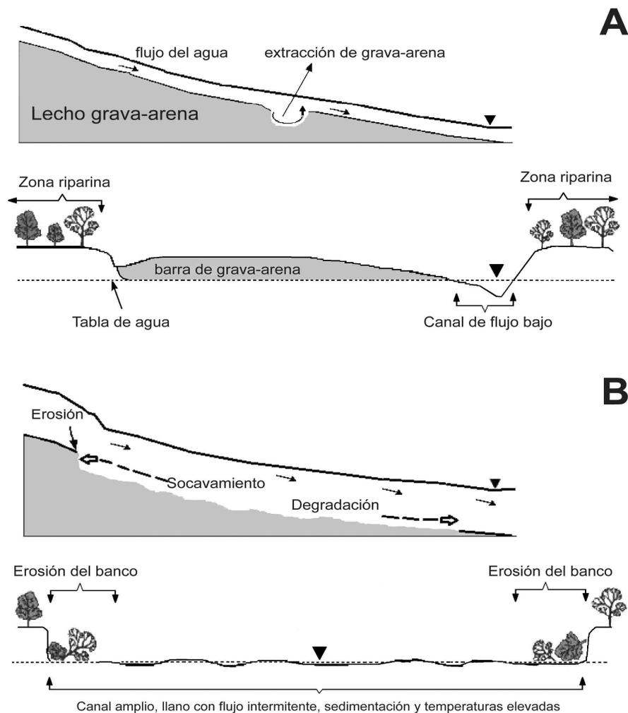
**Figura 9.** El efecto de la extracción excesiva de arena y grava del lecho de los ríos. A. Inicio, flujo permanente; B después de un tiempo el canal se amplía y el flujo es intermitente con agua de altas temperaturas. Modificado de Ponce (2016).
