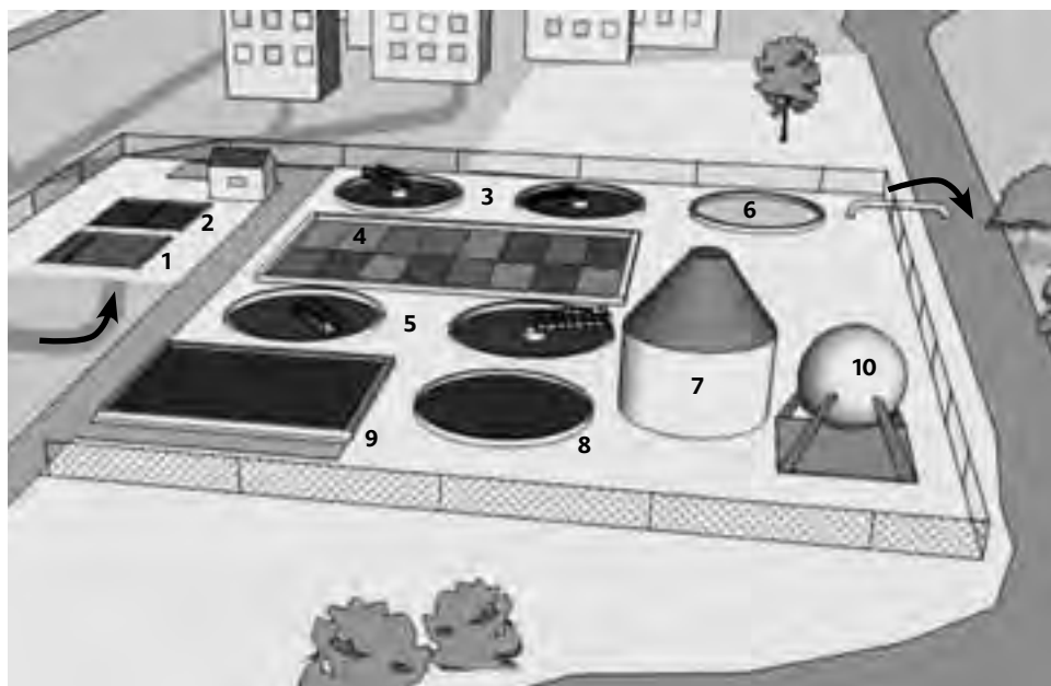
Obr. č. 4.3: Schéma bežnej čistiarne odpadových vôd.
