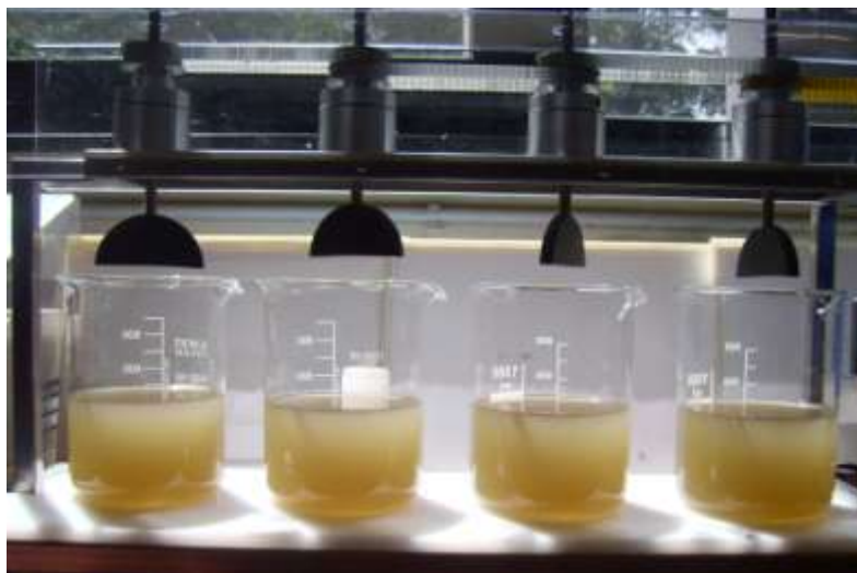
Abbildung 18: Optischer Aspekt der Ablauf der Vorklärung der Kläranlage Steinhof.
