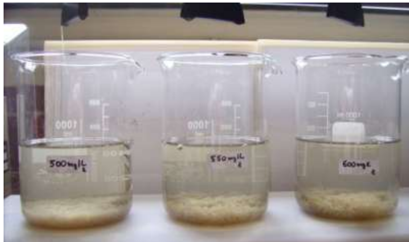
Abbildung 32: Optischer Aspekt der Dosierungen 500, 550 und 600 mg/L nach der Reaktion und Sedimentation mit Tanfloc® SH.
