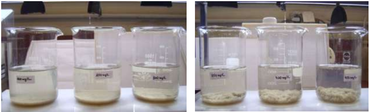
Abbildung 31: Optischer Aspekt des Abwassers nach der Zudosierung, Reaktion und Sedimentation von 200, 250, 300, 350, 400 und 450 mg/L Tanfloc® SH.
