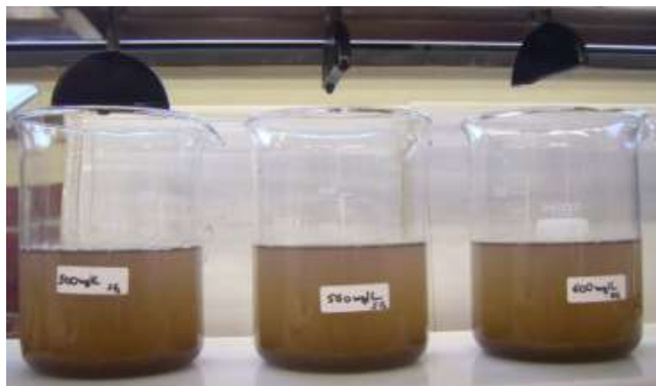
Abbildung 21: Optischer Aspekt des Abwassers nach der Zudosierung, Reaktion und Sedimentation von 500, 550 und 600 mg/L Tanfloc® SG.
