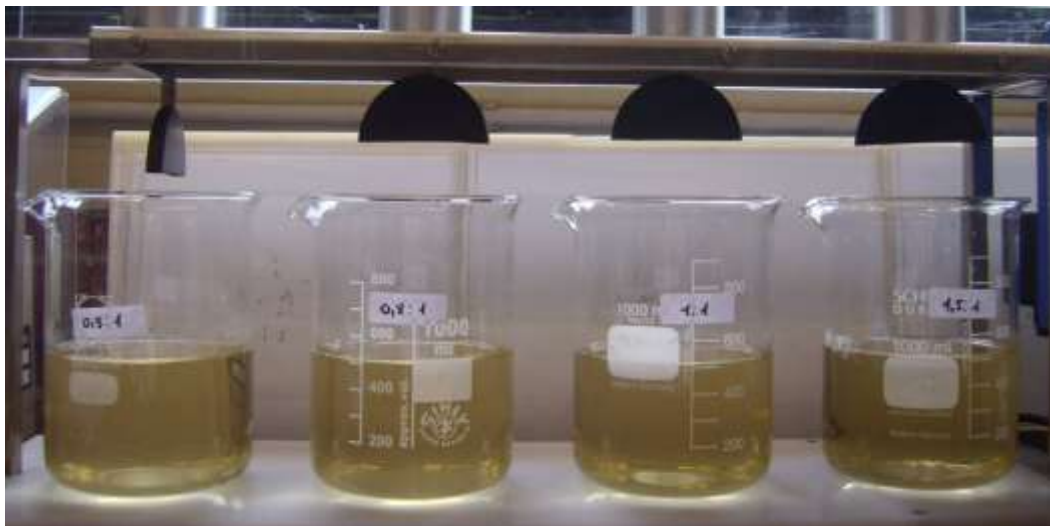
Abbildung 38: Optischer Aspekt des Konzentrates aus der Umkehrosmose nach der Einstellung des unterschiedlichen Verhältnissen bei pH-Wert 6,5.
