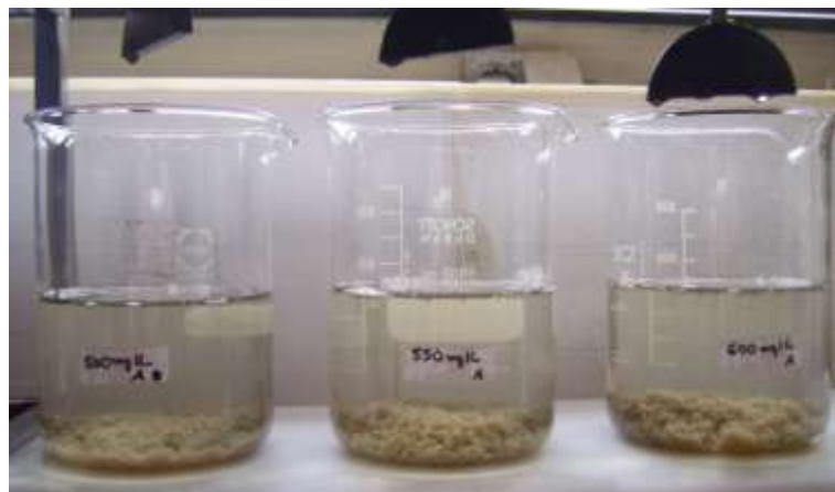
Abbildung 26: Optischer Aspekt des Abwassers nach der Zudosierung, Reaktion und Sedimentation von 500, 550 und 600 mg/L Tanfloc® SH.
