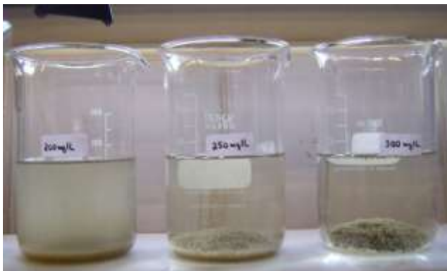
Abbildung 25: Optischer Aspekt des Abwassers nach der Zudosierung, Reaktion und Sedimentation von 200, 250, 300, 350, 400 und 450 mg/L Tanfloc® SH.
