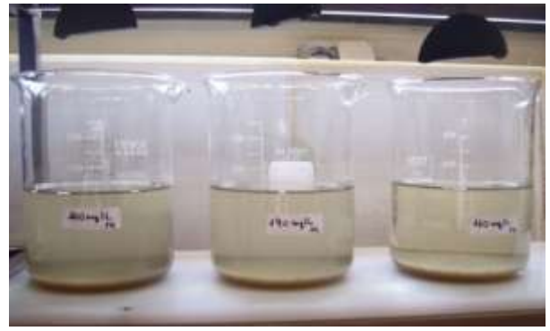
Abbildung 19: Optischer Aspekt des Abwassers nach der Zudosierung, Reaktion und Sedimentation von 60, 80, 100, 120, 140 und 160 mg/L Tanfloc® SG.
