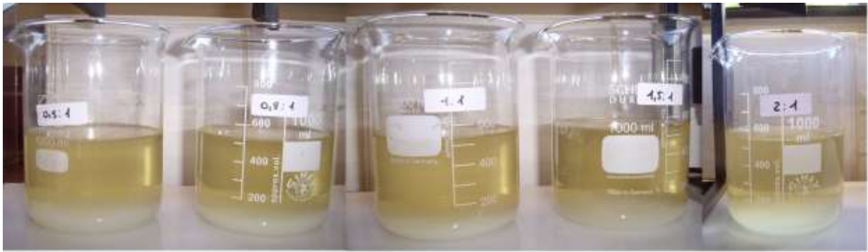
Abbildung 41: Flockenbildung nach der Magnesium-Zugabe bei pH-Wert 9,0.
