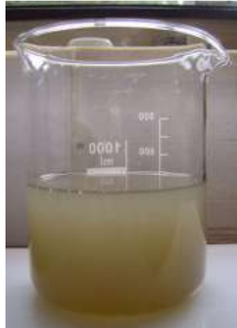
Abbildung 29: Optischer Aspekt der Ablauf der Vorklärung aus der Kläranlage Steinhof.
