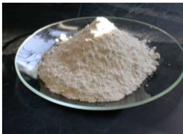
Abbildung 12: MAP-Kristallen nach der Konditionierung.
