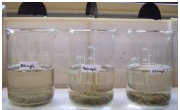
Abbildung 25: Optischer Aspekt des Abwassers nach der Zudosierung, Reaktion und Sedimentation von 200, 250, 300, 350, 400 und 450 mg/L Tanfloc® SH.
