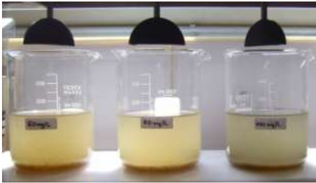
Abbildung 24: Optischer Aspekt des Abwassers nach der Zudosierung, Reaktion und Sedimentation von 60, 80, 100, 120, 140 und 160 Tanfloc® SH.
